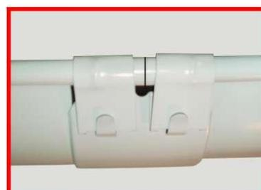
Выровняйте хомут по центру стыка, при этом желоба не должны соприкасаться между собой (расстояние между ними 2-3 мм). Застопорите хомут, надавив на фиксатор и прижав 2 пластины к фиксатору. Соединение уплотните герметиком.
