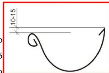
Определив общий уклон желоба (для нормального стока воды уклон желоба на 1 м.п. должен составлять 2,5 - 5 мм) прикрепите первый и последний крючок желоба на расстоянии 150 - 200 мм от конца свеса крыши. Натяните между ними шнур и прикрепите остальные крючки. Расстояние между крючками не должно превышать 1000 мм (рекомендуемый шаг 800 мм).
